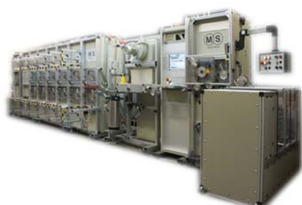
Установка для изготовления волоконных лент FRP 05
