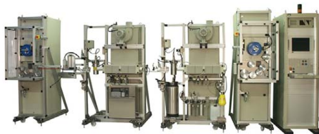
Impianto di colorazione fibre ottiche Medek & Schörner per velocità fino a 3000 m/min.
