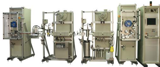
Medek & Schörner LWL-Färbearanlage für Geschwindigkeiten bis 3000 m/min
